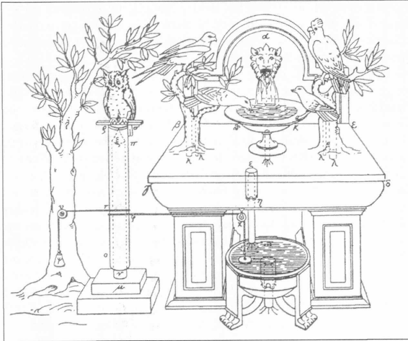
Automaton van Hero. Door het lopende water draait de uil weg, op dat moment gaan de vogels zingen, wanneer de uil weer naar hen terugdraait, zwijgen zij weer (bron: John W. Humphrey ed., Greek and roman technology: a sourcebook (Londen 1998) 64-65).
