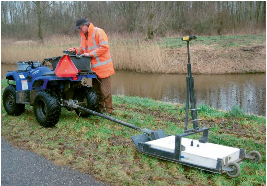
Fig. 3. Quad met daarachter de antenne en GPS gemonteerd op een slee (foto A.B.M. Overmeer, Nieuw Land).
