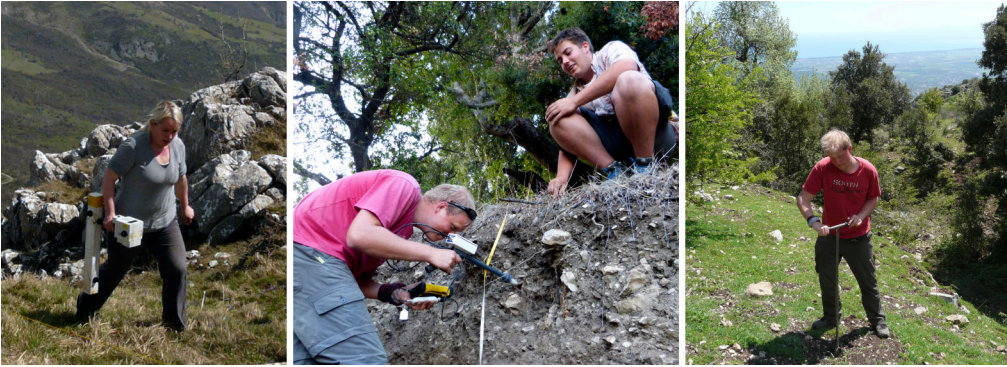
Fig. 3. Gebruikte veldwerkmethoden: Kayt Armstrong verzamelt magnetische gradiometriedata met een FM256 single sensor (links); Jelmer Wubs en Nikolaas Noorda voeren magnetische susceptibiliteitsmetingen uit op het profiel van de geul (midden); Jelmer Wubs boort met een Edelman-boor op het plateau (rechts). (Foto's W. de Neef, RUG/GIA).
