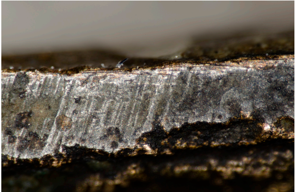
Fig. 6. Een detailopname van een deel van de achterrand van één van de objecten toont krassen in verschillende richtingen: zaagsporen of overblijfselen van het mechanisch reinigen (schuren). De breedte van het op de foto afgebeelde stuk is in werkelijkheid circa 1,5 mm (foto G. van Oortmerssen, RUG/GIA).
