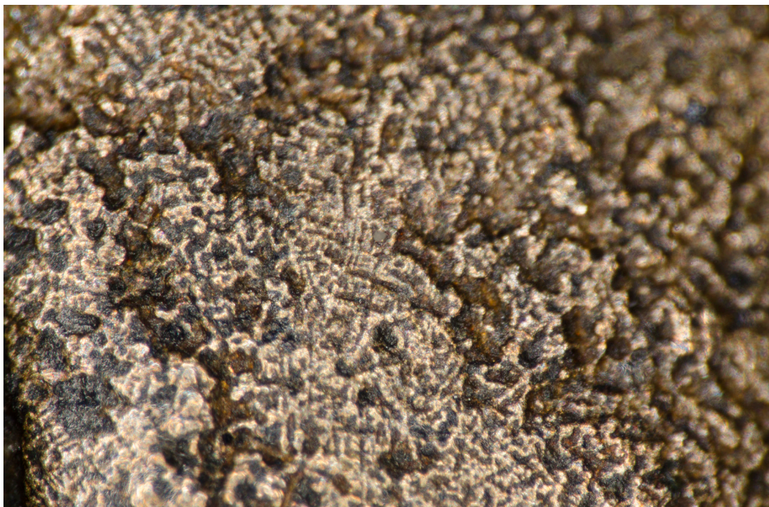
Fig. 2. Dendritische structuren, zichtbaar in het oppervlak van een van de beslagen, duidend op het gieten van het object in een mal. Het gebied in de afbeelding heeft in werkelijkheid een breedte van ongeveer 1,5 mm (foto G. van Oortmerssen, RUG/GIA).
