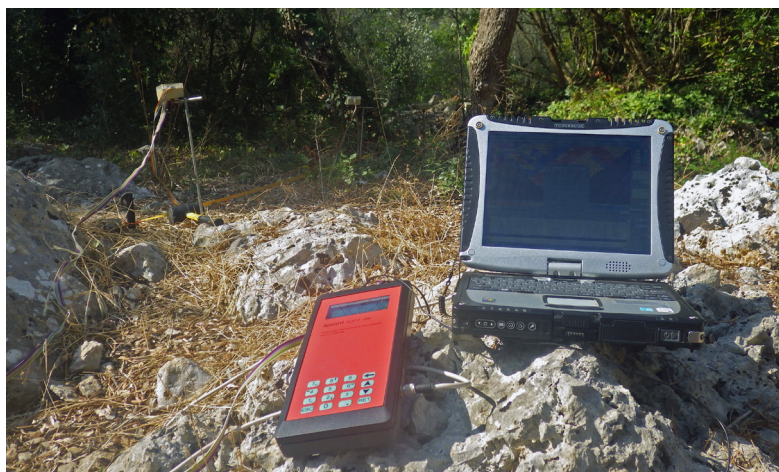
Fig. 5. De lichtgewicht elektrische weerstandsapparatuur 4PointLight met veldcomputer in actie buiten de grot La Sassa, juli 2016 (foto B. Ullrich, Eastern Atlas GmbH & CoKG).
